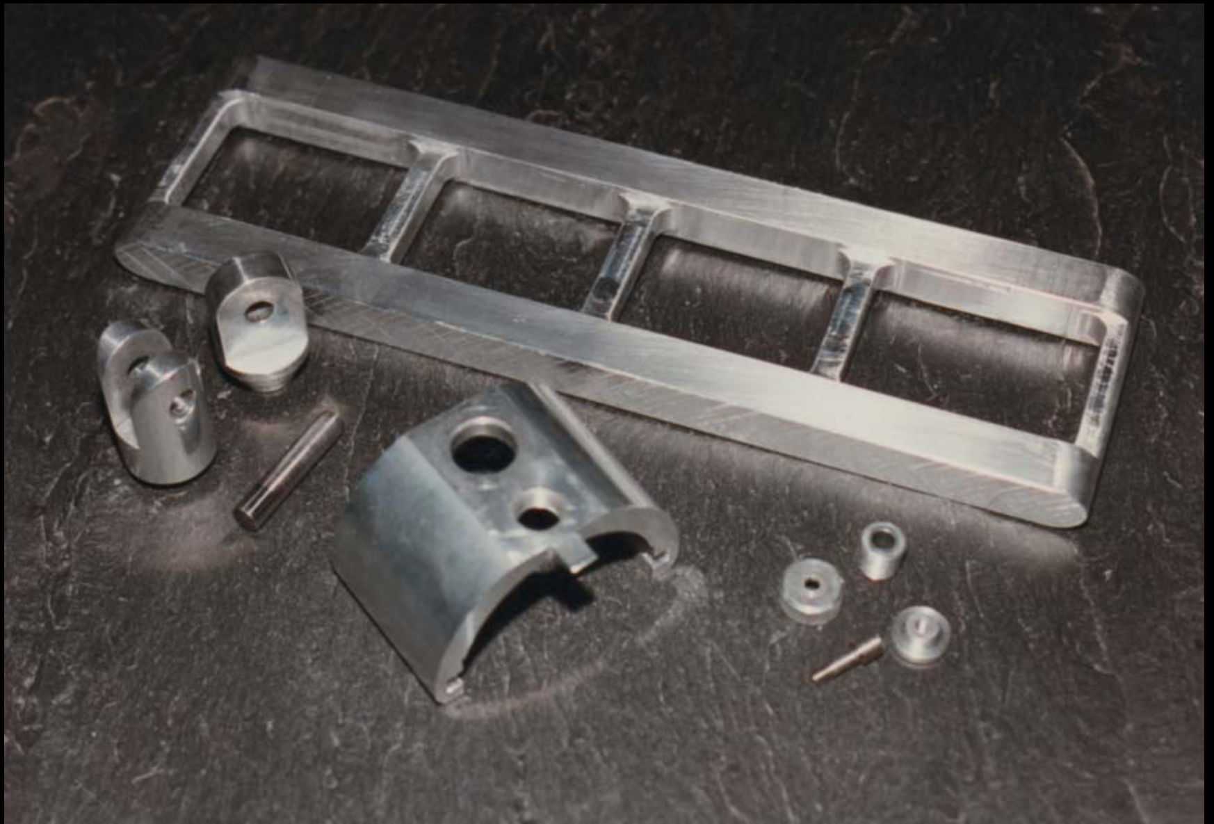
Einzelteile der Führungsschiene mit Schlitten
