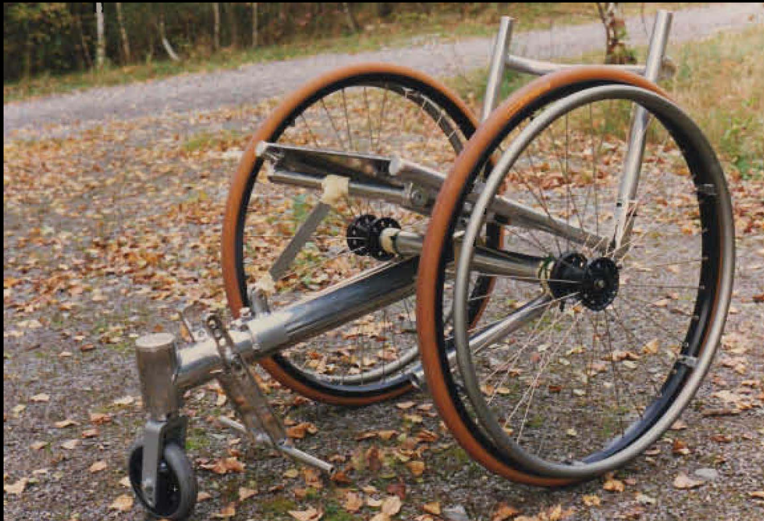
Rollstuhl mit vorgegebener Extremeinstellung des Schwerpunktes, mit noch fehlendem Klappmechanismus am Achsrohr und provisorischer vorder Sitzstütze
