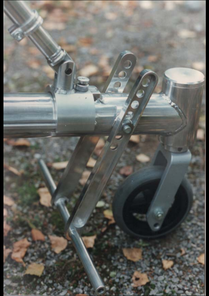
u.a. Aufnahmen für die noch nicht vorhandenen Fussplatten
